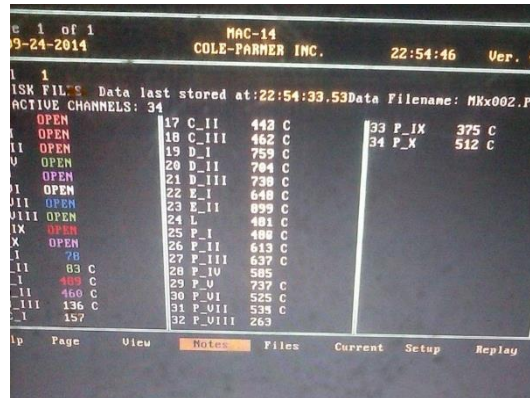
Figura 26. Captura de pantalla de las mediciones de temperaturas dentro un horno MK-2
