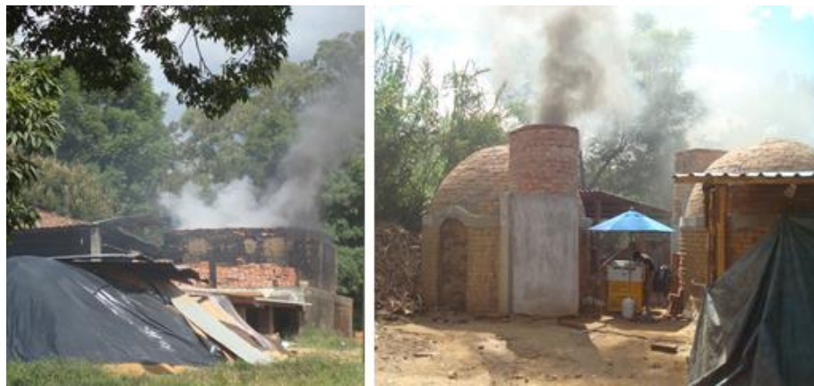
Figura 2. Emisiones a la atmósfera de un horno escocés (izquierda) y del horno MK-2 (derecha) en la Cd. de Oaxaca (Fuente propia)
