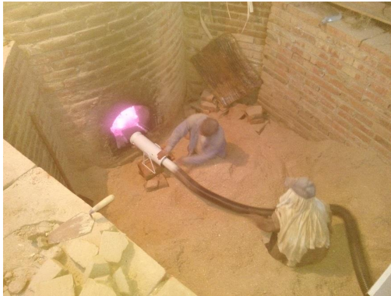
Figura 5. Dosificación de la mezcla de combustible-comburente en el hogar del horno MK-2
