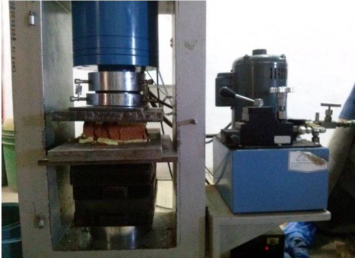
Figura 29. Colocación del ladrillo en la prueba de compresión
