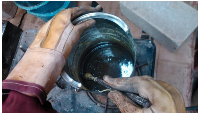
Figura 31. Fundición del azufre con ayuda de una varilla metálica
