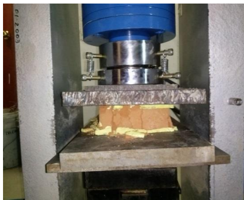
Figura 33. Fallas de un ladrillo
