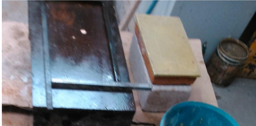
Figura 32. Engrasado de la placa, colocación de las varillas y cabeceo de una cara del ladrillo.
