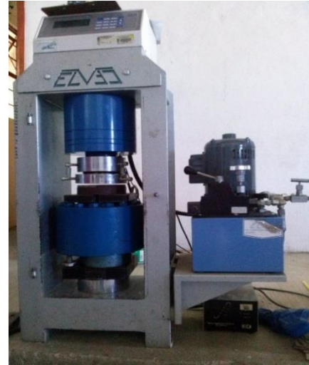
Figura 30. Prensa hidráulica utilizada en los ensayos
