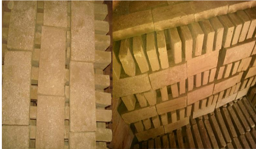
Figura 20. Acomodo de ladrillos en el nivel A
