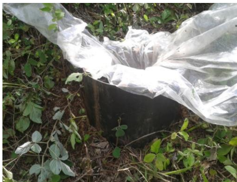
Figura 24. Disminución del impacto del agua al suelo en el anillo interno
