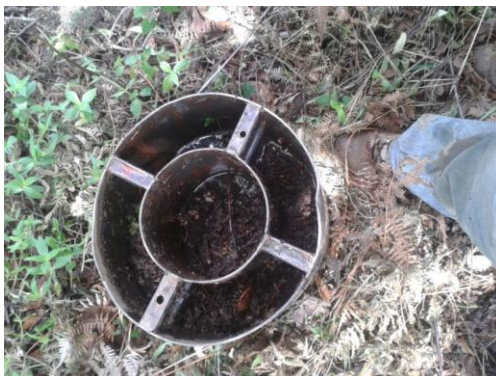
Figura 23. Colocación y verificación del infiltrómetro
