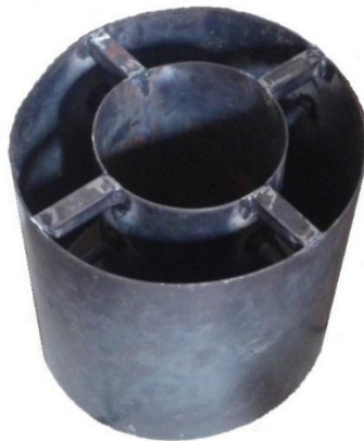
Figura 2. Infiltrómetro de doble anillo
