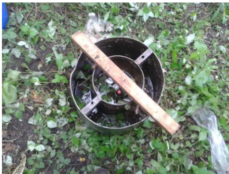
Figura 25. Medición del descenso del agua en el anillo interno
