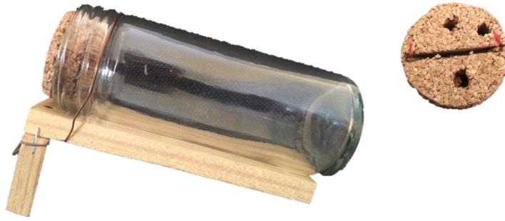
**Figura 22.** Dispositivo de prueba con soporte de corcho para probeta, con orificio para colocar termopar y orificios de entrada y salida de aire.
