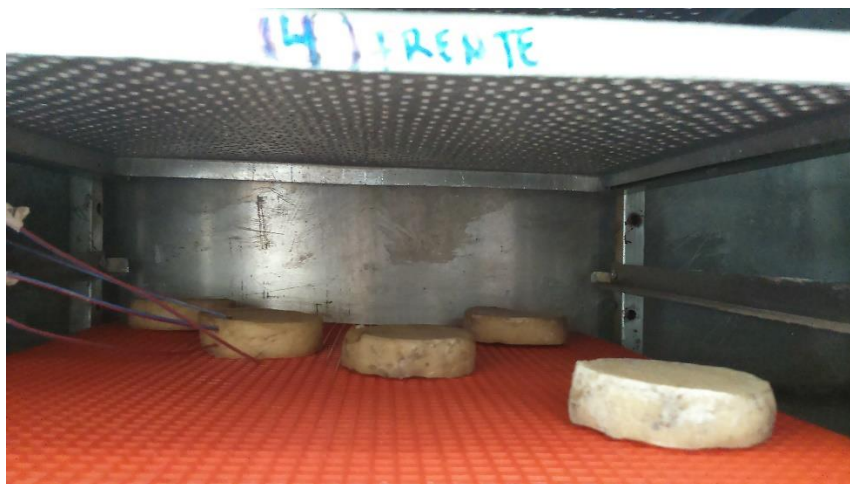
Figura 19. Termopares insertados en 3 puntos de la muestra
