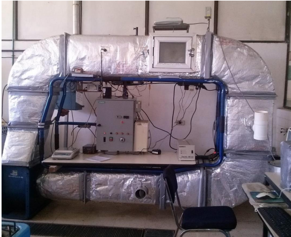
Figura 17. Túnel de secado por convección forzada
