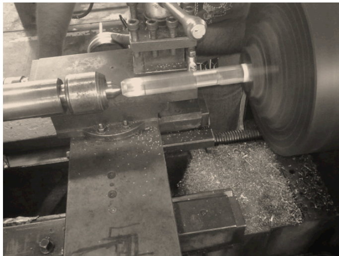
Figura 4.1.20: Torneado de la probeta de acrílico.
