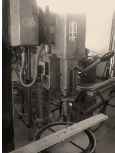
Figura 4.1.21: Taladro de columna utilizado en la elaboración de la estructura de retén.
