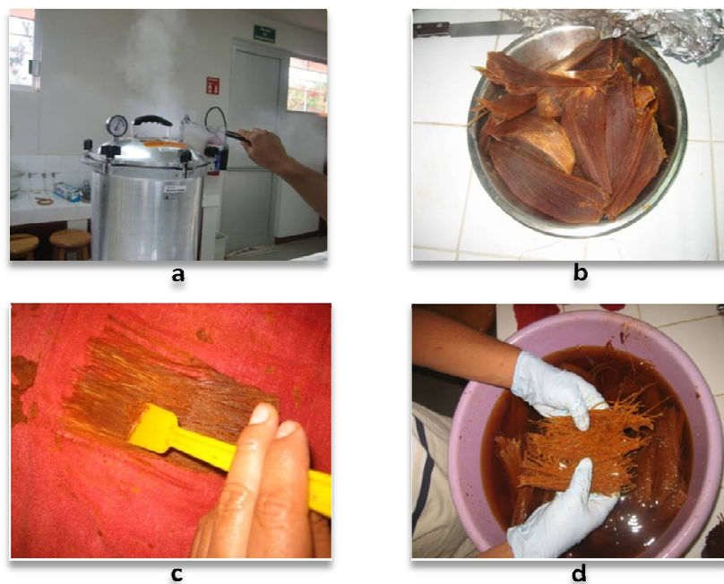
Figura. 18 Limpieza de las fibras de agave. a) Cocción de las pencas de agave, b) pencas de agave cocido, c) enriado de las fibras y d) lavado de las fibras de agave
