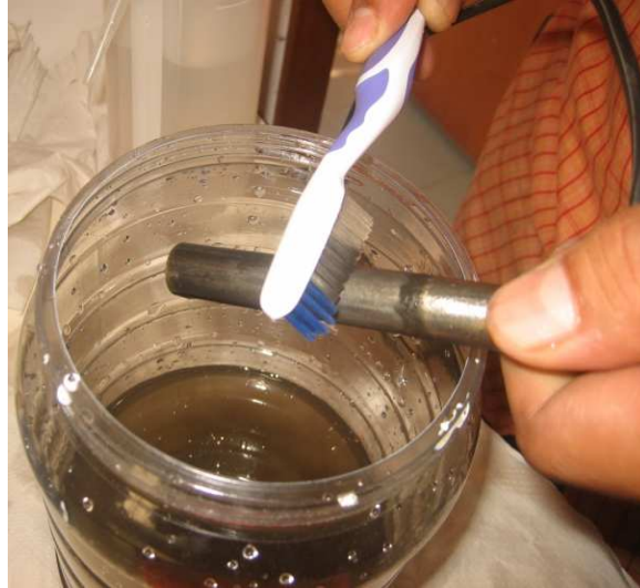
Figura. 25 Limpieza de las varillas.
