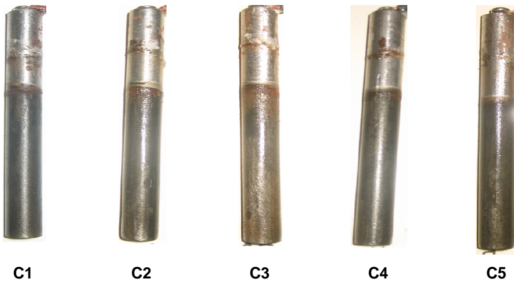
Figura. 49 Varillas sin recubrimiento, después de 22 días de inmersión en solución de NaCl.
