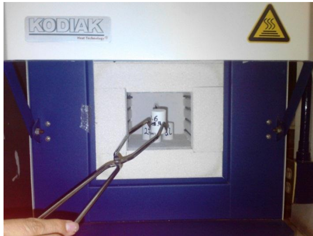
Figura 3.4 Calcinación de especímenes a 1000°C
