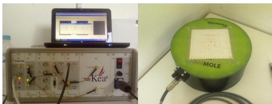
Figura 3.5 Equipo Kea 2 con magneto unilateral MOLE
