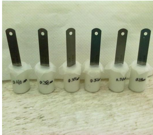
Figura 3.2 Simulación de grietas en especímenes de pasta de cemento blanco con relación a/c 0.55
