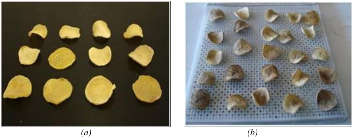
Figura 29. Muestras secas a velocidad de flujo de aire de 2.2\text{ m/s} (a) y a 0.6\text{ m/s} (b)
