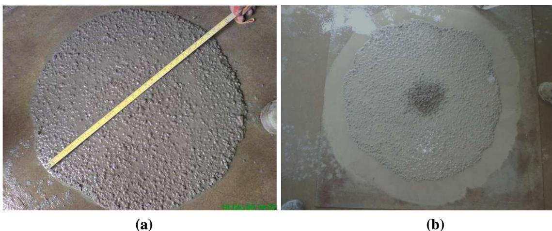
**Figura 4.20.** Extensibilidad del CAC con relación  $a/c=0.50$ , conteniendo a) la cantidad óptima de AMV y b) la cantidad inferior de AMV optima-60
