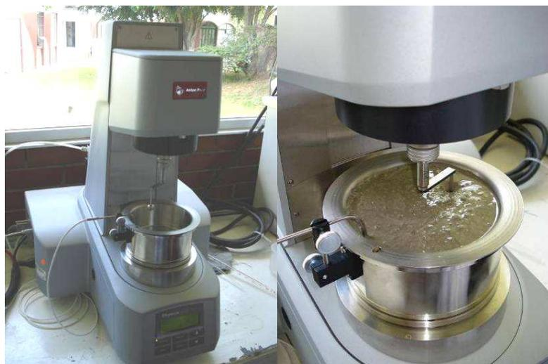
**Figura 3.3.** Reómetro Anton Paar Physica MCR 301 con su sistema de esferas.
