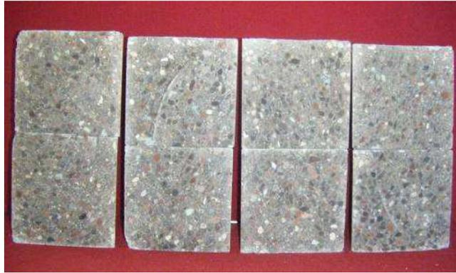
**Figura 4.22.** Concreto autoconsolidable con la cantidad óptima de AMV en estado endurecido mostrando distribución homogénea de los agregados gruesos.
