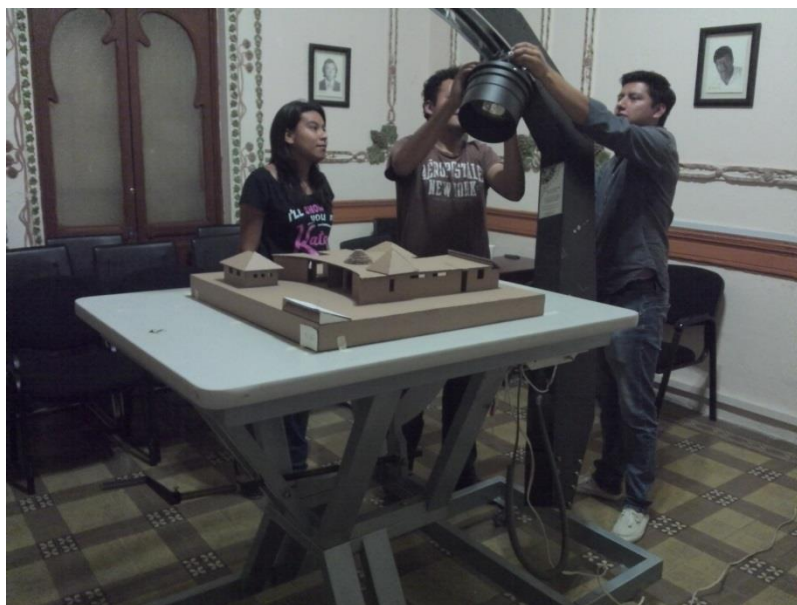
Figura 3.26 Preparación del heliodón para la prueba de sombreamiento. Fuente propia.
