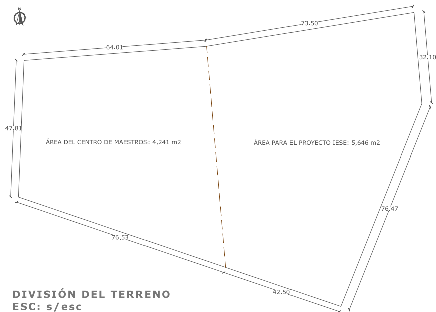
Figura 20. Dimensiones del predio, área del centro de maestros 2005 y del proyecto IESE Fuente: Elaboración propia
