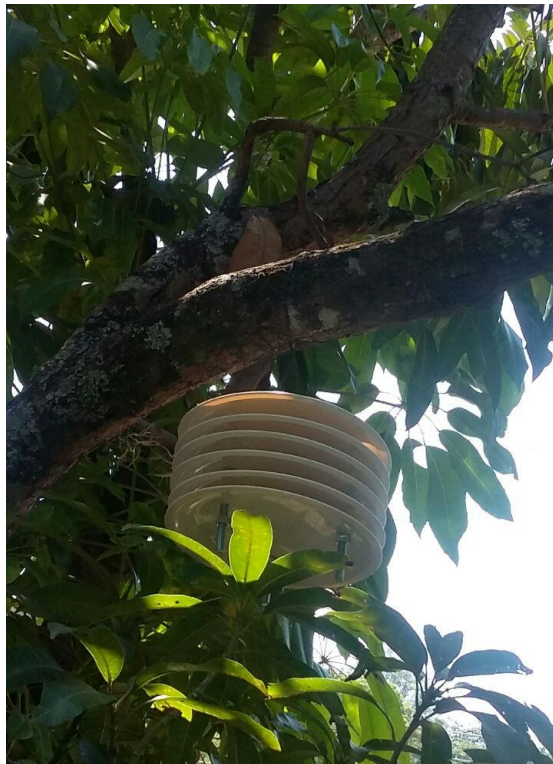
Figura 31: Instalación del registrador de temperatura marca “Hobo” en el espacio exterior Fuente: Foto tomada por el autor
