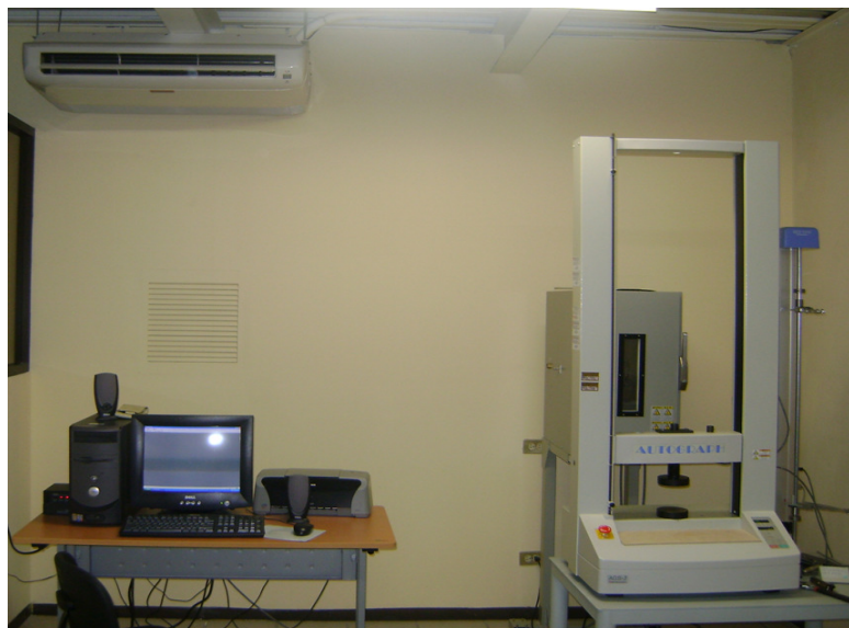
Figura 32. Máquina para ensayos estáticos Shimadzu modelo Autograph AGS-J
