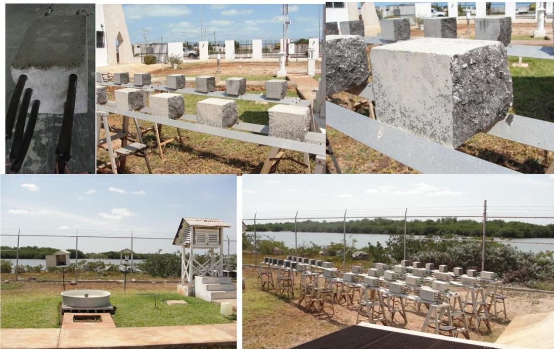
Figura 3.1.3.I Vigas de concreto DURACON, indicando la colocación del refuerzo y los cortes efectuados, cara principal expuesta a vientos dominantes y vista de la estación climatológica de CONAGUA en Progreso, Yucatán, Mex.
