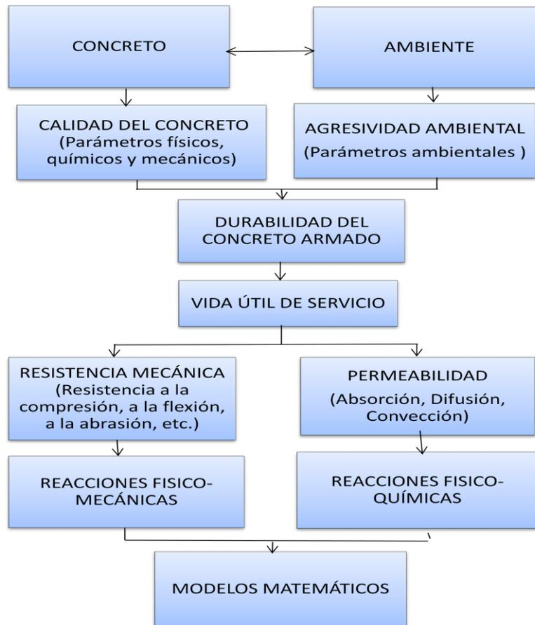
Figura 2.1.I Modelo conceptual de la durabilidad de estructuras de concreto, partiendo de la interrelación entre el concreto y el ambiente de exposición, hasta el desarrollo de modelos matemáticos basados en la caracterización física, química y/o mecánica del concreto armado.
