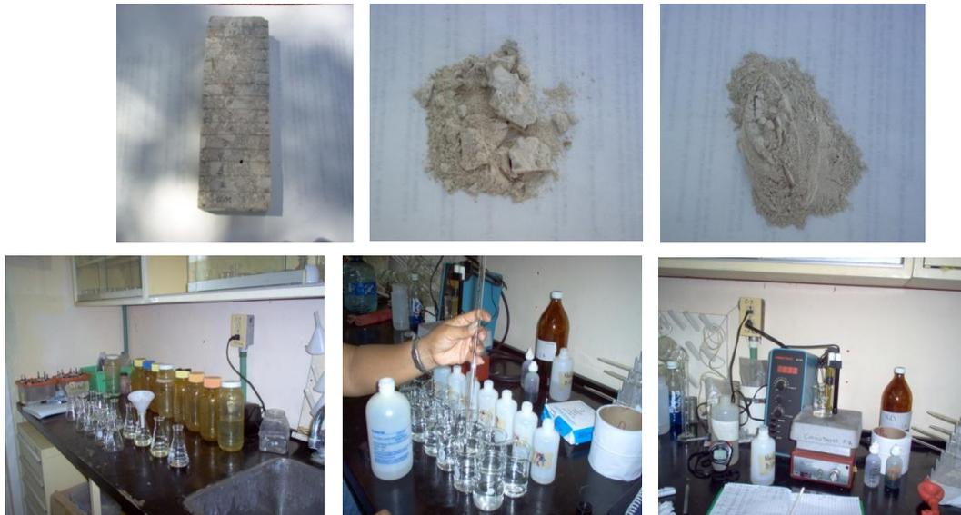
Figura 3.1.3.III Técnica para obtención de polvo y Método de ión selectivo para determinación de cloruros
