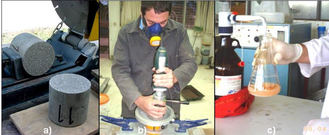
**Fig.3.17.** Prueba de difusión de cloruros: a) corte de cilindros, b) extracción de polvos y c) determinación de contenido de cloruros
