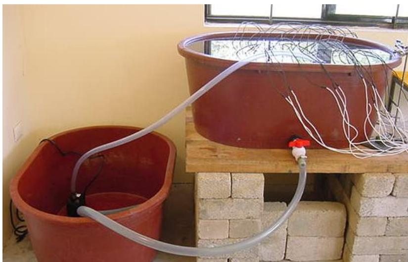
**Fig.3.13.** Acondicionamiento de ambiente agresivo simulado
