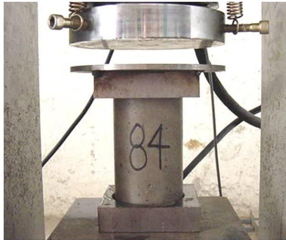
**Fig.3.15.** Ensayo de resistencia a la compresión.
