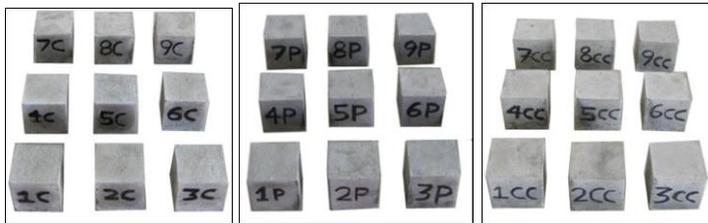
**Fig.3.10.** Cubos después de ser desmoldados y marcados.
