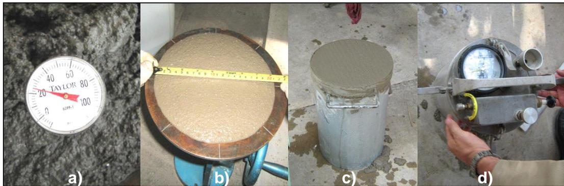
**Fig.3.14.** Pruebas en estado fresco: a) temperatura, b) fluidez, c) peso volumétrico y d) contenido de aire.
