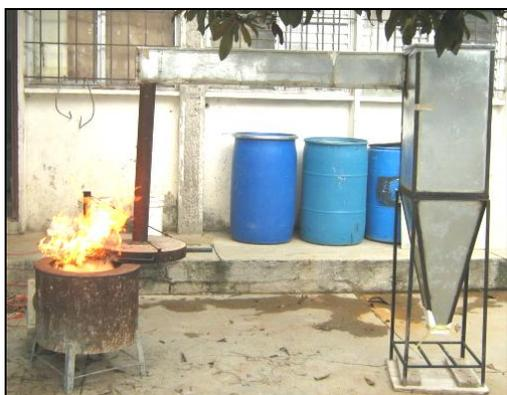
**Fig.3.5.**Filtro para sedimentar cenizas
