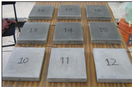
**Fig.3.18.** Placas de ferrocemento antes de someterse al ambiente agresivo simulado.
