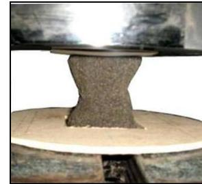
**Fig.3.11.** Ensayo a compresión para determinar IARs
